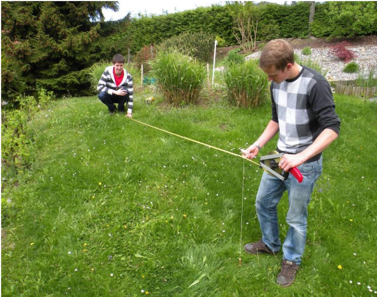
Abbildung: Messen mit Messband bei geneigtem Terrain
